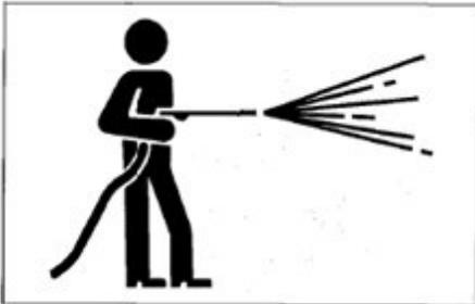
Bitte reinigen Sie die Maschine vor der Wartung. Stellen Sie den Motor vor der Reinigung der Maschine ab. Schützen Sie die elektrischen Teile vor dem Eindringen von Wasser. Das Eindringen von Wasser in die elektrischen Teile kann zu Kurzschlüssen oder Fehlfunktionen führen. Reinigen Sie die Batterie, die elektronischen Steuereinheiten, die Sensoren, die Steckverbinder und die Kabine nicht mit Wasser oder Dampf.
