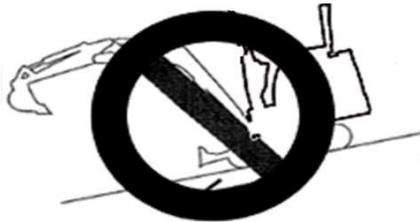
**Fahren Sie nicht mit angehobenem Anbaugerät einen steilen Hang hinunter.**
