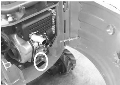
1. Entriegeln Sie die hintere Abdeckung und öffnen Sie sie bis zum Anschlag.
