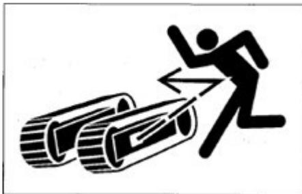
Im Kettenrad wird das Fett unter hohem Druck eingespritzt. Wenn die Spannung nicht gemäß dem folgenden vorgeschriebenen Verfahren eingestellt wird, kann das Fettdruckbegrenzungsventil herausgeschleudert werden und Verletzungen verursachen.
