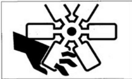
Halten Sie sich von allen rotierenden und beweglichen Teilen fern. Das Verfangen von Händen oder Werkzeugen in rotierenden oder beweglichen Teilen kann zu schweren Verletzungen oder sogar zum Tod führen. Werkzeuge oder andere Gegenstände, die in den Lüfter oder den Lüfterriemen fallen oder dort hineingelangen, werden zerkleinert oder zerschnitten. Werfen oder stecken Sie niemals Gegenstände in den Lüfter oder den Lüfterriemen.
