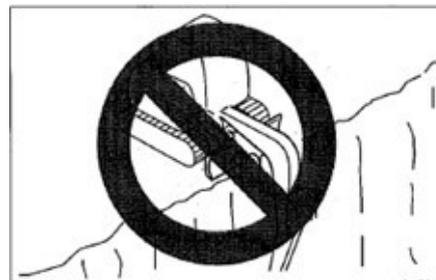
Bei tiefen Grabungsarbeiten ist zu beachten, dass das Planierschild, wenn es sich vorne befindet, nicht gegen den Ausleger und die Schaufel stößt. Bringen Sie das Planierschild während des Betriebs nach Möglichkeit an der Rückseite der Maschine an.
