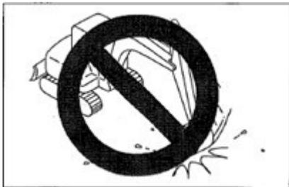
Dies verkürzt die Lebensdauer der Schaufelvorrichtung. Graben Sie mit Hydraulikkraft.
