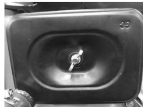
3. Lösen Sie die Mutter und entfernen Sie das Filterelement.
