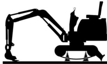
2. Heben Sie den Maschinenkörper mit dem Arbeitsgerät an.
