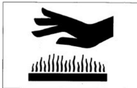
Bitte stellen Sie den Motor ab und warten Sie, bis die Maschine abgekühlt ist, bevor Sie Wartungsarbeiten durchführen.
