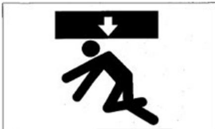
Bevor Sie Wartungs- oder Reparaturarbeiten unter der Maschine durchführen, senken Sie alle beweglichen Arbeitsvorrichtungen auf den Boden oder in die niedrigste Position ab und sichern Sie die
