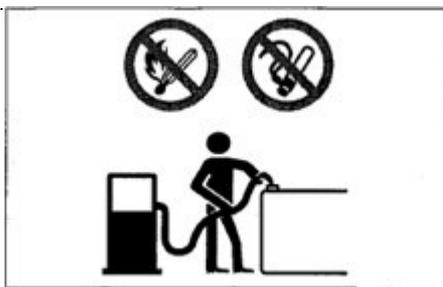
Das Rauchen und offenes Feuer sind während des Betankens und in der Nähe der Tankstelle verboten. Demontieren Sie den Tankdeckel nicht und tanken Sie nicht, während der Motor läuft oder noch nicht abgekühlt ist. Spritzen Sie keinen Kraftstoff auf heiße Oberflächen der Maschine. Tanken Sie den Kraftstofftank an einem gut belüfteten Ort. Füllen Sie den Kraftstofftank nicht bis zum Rand. Lassen Sie Platz für die Ausdehnung des Kraftstoffs.
