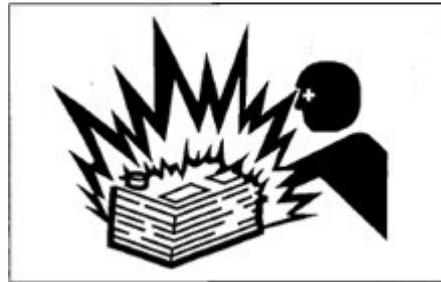
Bitte trennen Sie die Batteriekabel vor Arbeiten oder Schweißarbeiten am elektronischen System. Trennen Sie zuerst das Minuskabel (-) der Batterie. Schließen Sie beim Wiederanschießen zuletzt das Minuskabel (-) der Batterie an.
