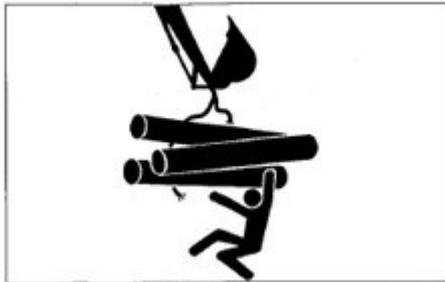
Diese Maschine ist speziell für Grabungsarbeiten konzipiert. Daher ist sie nicht mit Sicherheitsvorrichtungen für Hebearbeiten ausgestattet. Seien Sie besonders vorsichtig, wenn Sie diesen Bagger für Hebearbeiten einsetzen. Überlasten Sie die Maschine beim Heben nicht. Eine Überlastung kann zum Umkippen der Maschine führen und
