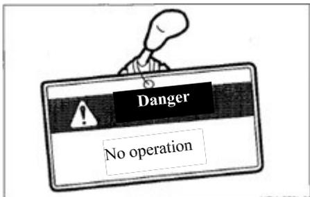
Bringen Sie den Warnhinweis **„Nicht in Betrieb“** an einer gut sichtbaren Stelle an, z. B. am Starterschalter und am Joystick.
