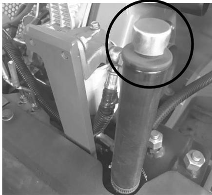
**Wichtig:** Beim Nachfüllen von Öl darf der Ölstand nicht über der Obergrenze liegen. Andernfalls kann der Hydraulikkreislauf beschädigt werden oder es kann zu Ölspritzern kommen. Wenn der Ölstand aufgrund von Unachtsamkeit zu hoch ist, stellen Sie den Motor ab, warten Sie, bis das Hydrauliköl abgekühlt ist, und lassen Sie das überschüssige Öl aus der Ölablassöffnung ab.
