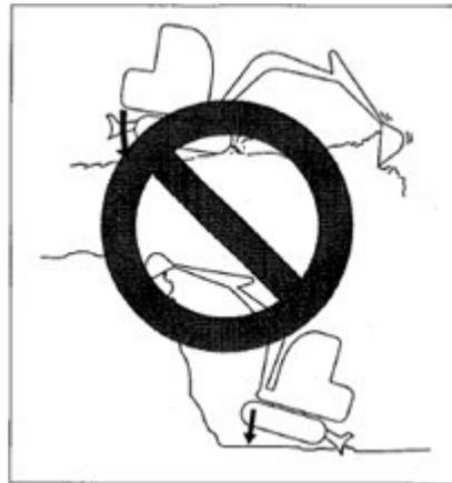
Eine zusätzliche Belastung der Maschine verkürzt deren Lebensdauer. Nutzen Sie beim Graben die Hydraulikkraft der Zylinder durch geringe Tiefe und großen Hub.
