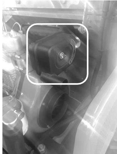
2. Lösen Sie die Flügelmutter und entfernen Sie die Abdeckung.
