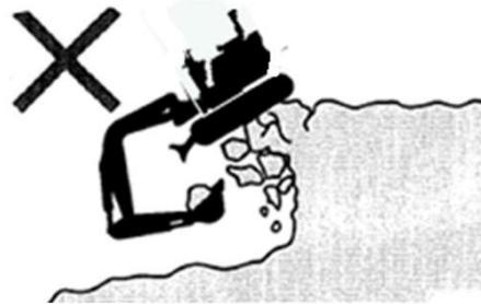
Halten Sie einen sicheren Abstand zwischen der Maschine und dem Rand der Aushubstelle ein. Graben Sie nicht vor der Maschine.
