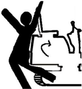
Legen Sie niemals Ihre Hände, Füße oder andere Körperteile zwischen den Aufbau und das Fahrgestell oder die Ketten, zwischen den Maschinenkörper und die Arbeitsvorrichtung oder zwischen den Zylinder und die beweglichen Teile. Während der Bewegung der Maschine ändern sich diese Abstände und können zu schweren Verletzungen oder zum Tod führen.
