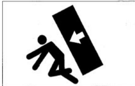
Sollten während der Demontage oder Installation vorübergehend schwere Gewichte oder Anbauteile auf dem Boden abgestellt werden müssen
