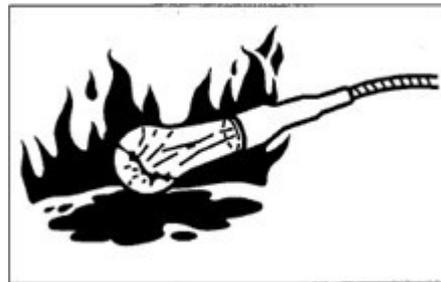
Verwenden Sie bei der Überprüfung von Kraftstoff, Schmieröl, Kühlmittel und Batterieelektrolyt explosionsschutz Lampen, um Brände und Explosionen zu vermeiden. Andernfalls kann es zu einer Explosion kommen, die schwere Verletzungen verursachen kann.
